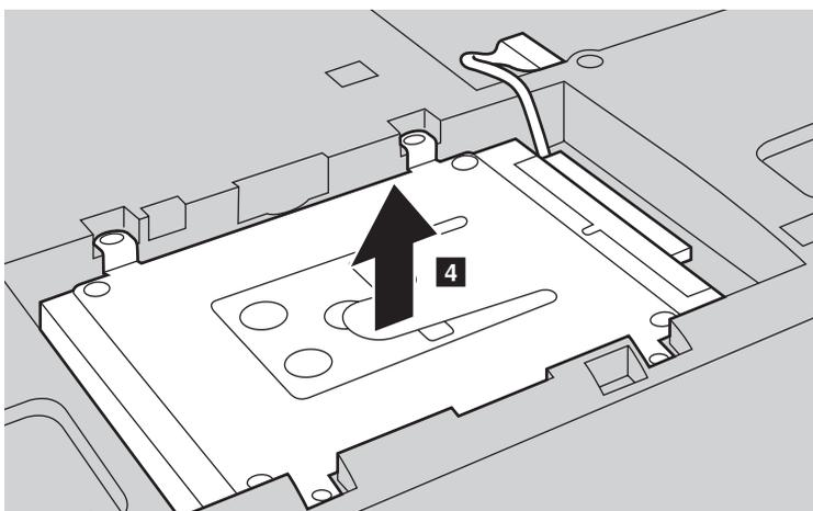
**Примечание.** Извлекайте жесткий диск (в металлическом корпусе) осторожно, чтобы не допустить обрыва соединения с разъемом SATA.
