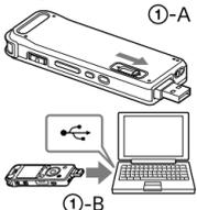
1 Зарядіть цифровий диктофон. Посуньте важіль-перемикач USB DIRECT у напрямі стрілки (1-A) та вставте з'єднувач USB у роз'єм USB увімкненого комп'ютера (1-B).
