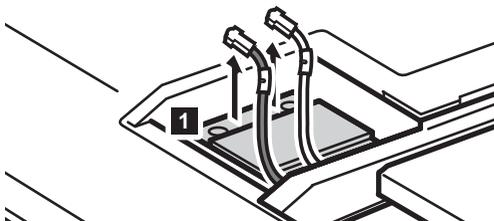
**Примечание.** На некоторых моделях установлена плата ЛВС, оснащенная только одним кабелем (черный).
