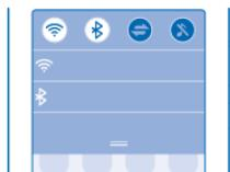
Необходимо быстро переключить телефон в беззвучный режим? Вместо перехода в меню телефона на большинстве экранов можно быстро изменить некоторые параметры и просмотреть уведомления с помощью меню, которое открывается в верхней части экрана.
