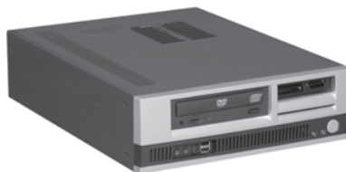
Рис. 2.2. Корпус системного блока Desktop
