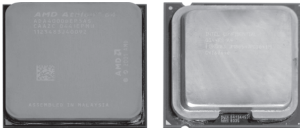
Рис. 2.4. Процессоры AMD Athlon 64 и Intel Pentium/Core
