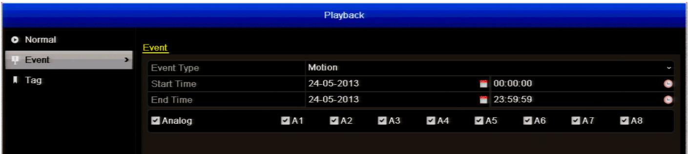
Кнопки **Поиск событий меню (выше)** показывает записи, созданные при срабатывании детекторов движения DVR. В 4-канальной модели можно выбрать до четырех камер и до восьми камер в 8-канальной модели.
