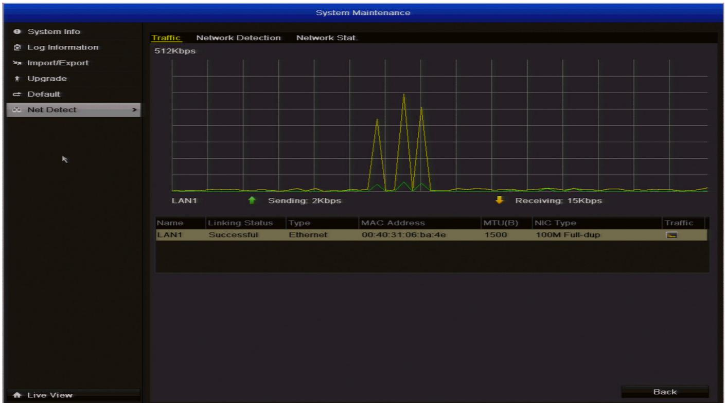
Кнопки **Обслуживание: Меню Net Detect** позволяет вам проверять сетевой трафик и получать от DVR в реальном времени такую информацию как определение сети, статус сети, отправка/получение сетевого трафика.
