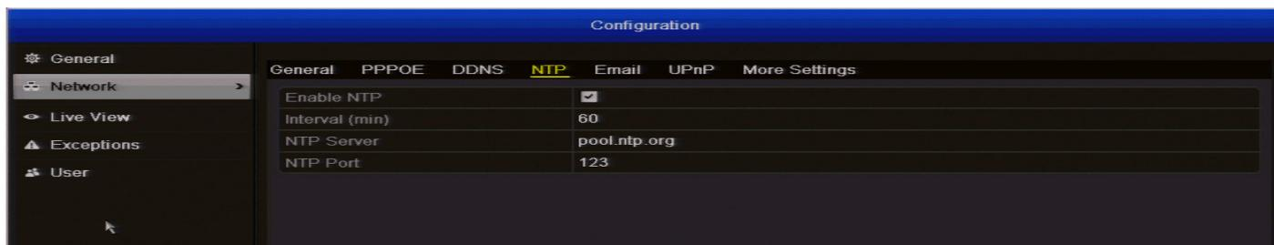
**NTP:** Сетевой протокол синхронизации времени. Если ваш DVR подключен к сети Интернет, вы можете настроить автоматическую синхронизацию времени с онлайн-сервером.
