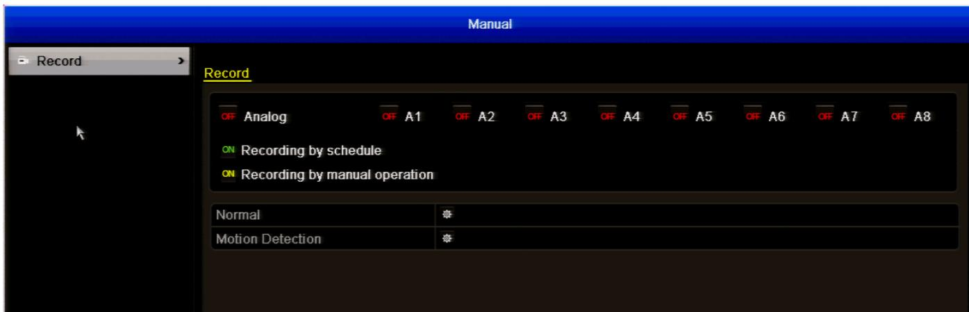
Кнопки **Вручную: Запись Меню** позволяет вам изменять любые расписания записи по умолчанию. Можно изменить расписание записи для каждой подключенной камеры. Если нажать кнопку рядом с **Аналог**, то запись со всех камер будет остановлена. Также вы можете управлять каждой камерой, нажав кнопку рядом с соответствующим названием камеры. Вы можете выбрать нормальную запись (Запись в ручном режиме) или запись в режиме обнаружения движения (Запись по расписанию).
