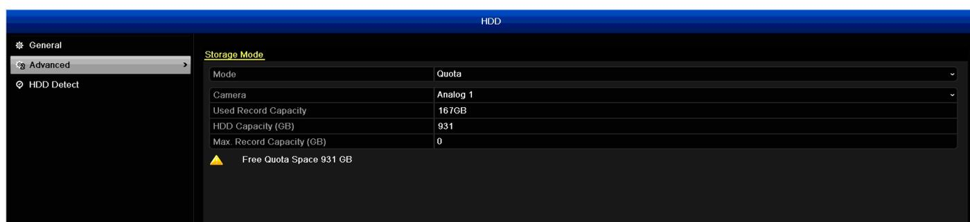
Кнопки **Жесткий диск: Дополнительно Меню** позволяет вам настроить на жестком диске квоту для каждой камеры, подключенной к DVR. Для каждой камеры можно выделить определенное пространство на жестком диске.
