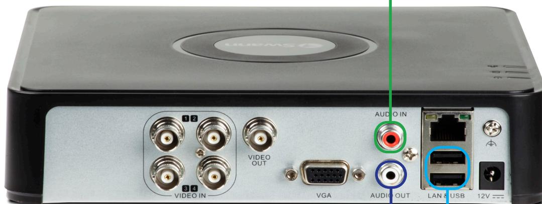
Порт аудио выхода можно использовать для подключения стереодинамиков, наушников или других внешних звуковых устройств.
