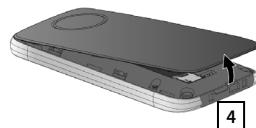
Если требуется **снять крышку аккумуляторного отсека**, выполните следующее.
