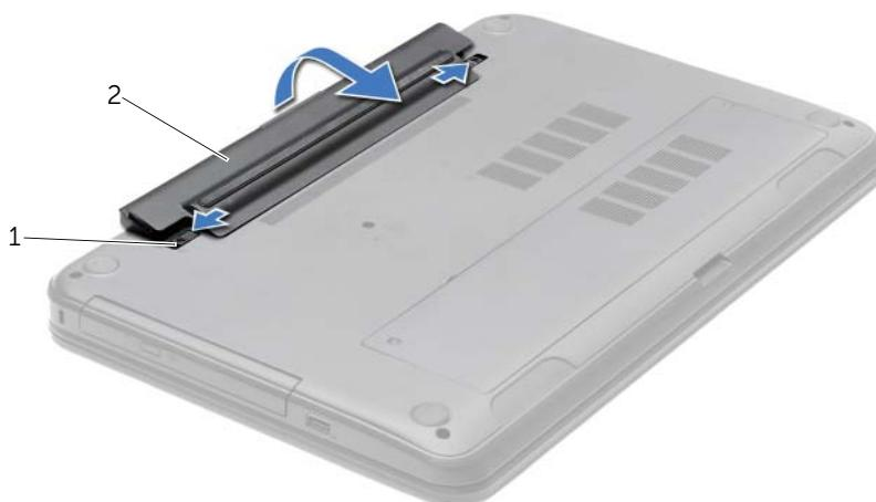
1 фиксаторы аккумулятора (2)
