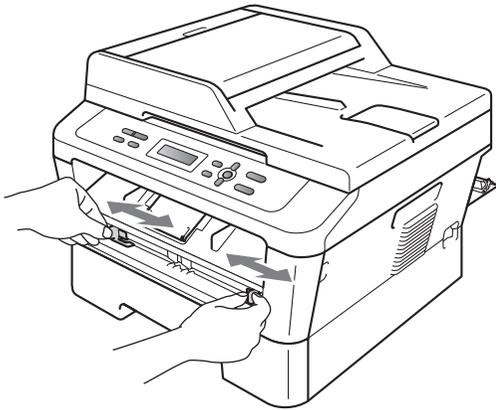
7 Обеими руками вставьте один лист бумаги формата A4 или Letter в слот для ручной подачи до контакта переднего края бумаги с роликом подачи бумаги. Когда почувствуете, что устройство захватило бумагу, отпустите ее. Устройство начинает процесс очистки фотобарабана.
