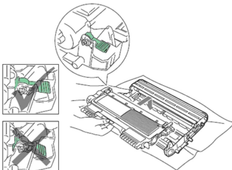
6. Очистите коронирующий провод внутри фотобарабана, осторожно несколько раз сдвинув зелёный ползунок справа налево и слева направо.
