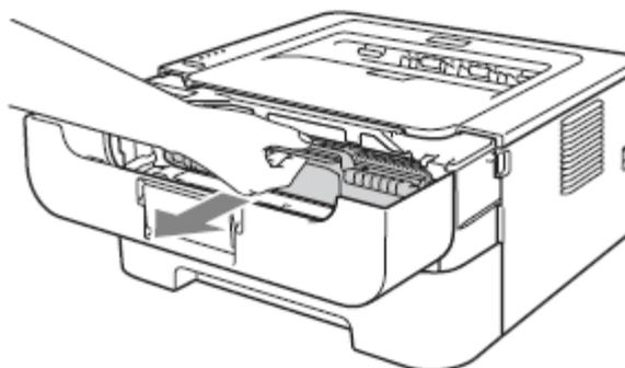
Одной рукой держите устройство Brother, а другой - фотобарабан. Потяните фотобарабан на себя, а затем приподнимите.
