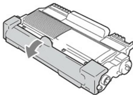
5. Плотно вставьте новый тонер-картридж в узел фотобарабана так, чтобы он зафиксировался на месте со щелчком. При правильной установке тонер-картриджа зелёный рычаг блокировки поднимется вверх автоматически.
