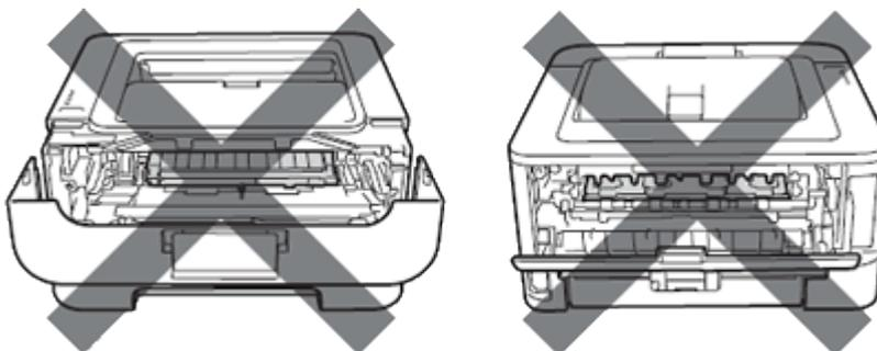
3. Извлеките блок фотобарабана и тонер-картриджа.
