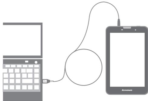
Можно подключить IdeaTab к порту USB на ПК с помощью входящего в комплект кабеля для зарядки или обмена данными с ПК.
