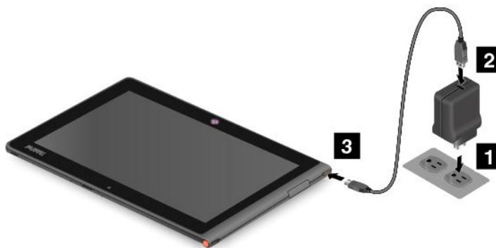
Рис. 4. Подключение адаптера электропитания к планшету
