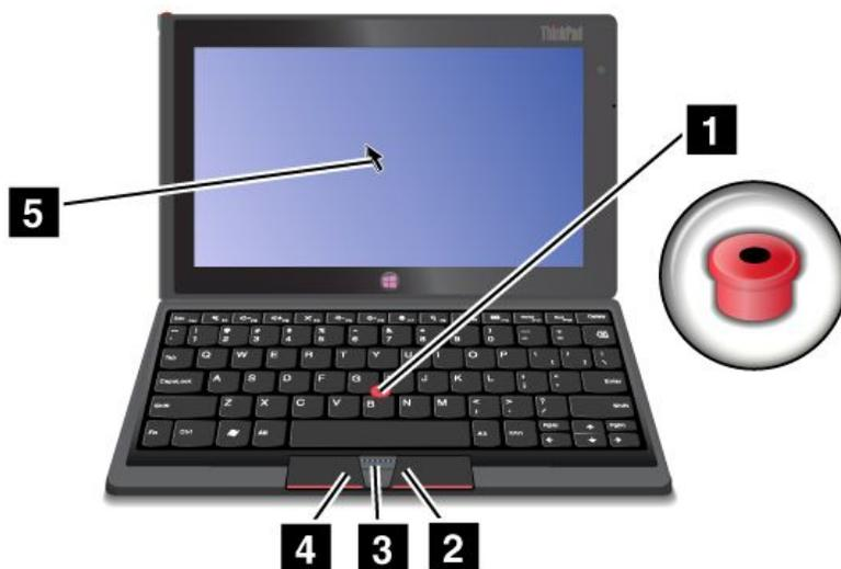
Рис. 9. Использование манипулятора Optical TrackPoint
