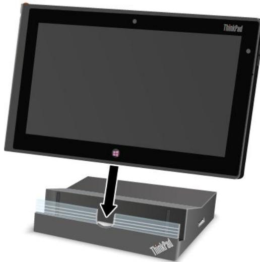
Рис. 10. Установка планшета в док-станцию
