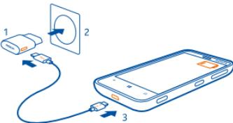
2. После полной зарядки аккумулятора отключите зарядное устройство от телефона, а затем от сетевой розетки.
