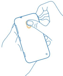
**2.** Сдвиньте держатель карты памяти до его разблокировки, затем поднимите держатель.
