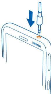
Не подключайте аппаратуру, которая формирует выходной сигнал, поскольку в результате устройство может оказаться повреждено. Не подключайте источники напряжения к звуковому разъему. При подключении к аудиоразъему внешнего устройства или мини-гарнитуры, отличных от рекомендованных для данного устройства, уделите особое внимание уровню громкости.
