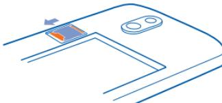
**5. Прижмите нижнюю часть задней панели к нижней части телефона и нажмите на заднюю часть панели до ее фиксации на месте.**
