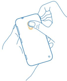
2. Если аккумулятор установлен в телефоне, извлеките его.
