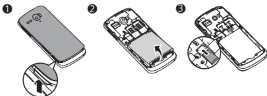
1. Снимите крышку аккумуляторного отсека.
