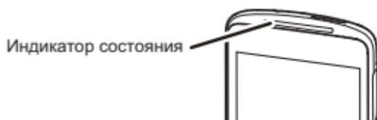
Зеленый: аккумулятор заряжен на 90 % (при подключении зарядного устройства)
