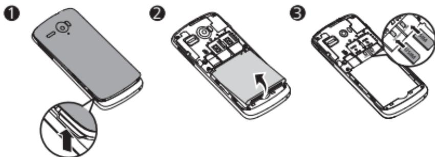
1. Снимите крышку аккумуляторного отсека.
