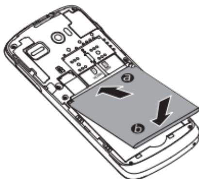
1. Вставьте аккумулятор в аккумуляторный отсек стороной с пометкой **a** (где расположены контакты).
