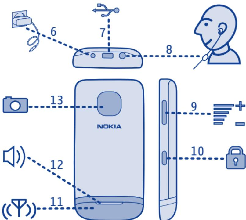
6 Разъем для подключения зарядного устройства
