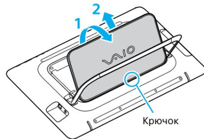
! После установки аккумулятора зацепите заднюю панель за крючок, а затем закройте ее.
