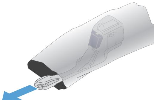
5. Сначала вставьте нижнюю часть нового модуля в устройство и затем протолкните верхнюю часть до щелчка.
