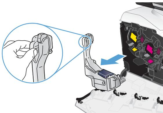
3. Поместите синий колпачок на синее отверстие в верхней части модуля.
