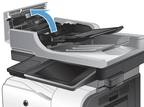
3. С помощью сжатого воздуха или ткани без ворса, смоченной в теплой воде, удалите видимые ворсинки и пыль с каждого ролика подачи бумаги и разделительной пластины.
