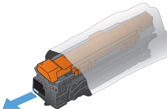
4. Возьмитесь за обе стороны картриджа с тонером и осторожно покачайте его, чтобы равномерно распределить тонер внутри картриджа.
