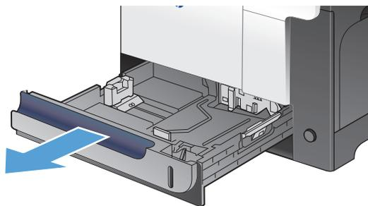
2. Отрегулируйте ограничитель длины и ширины бумаги: нажмите на регулировочные защелки и переместите ограничители согласно длине/ширине используемой бумаги.
