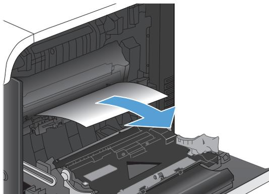
7. Проверьте наличие бумаги в роликах лотка 2. Потяните вверх два зеленых рычага, чтобы открыть дверцу доступа к замятой бумаге. Удалите замятую бумагу и закройте дверцу.
