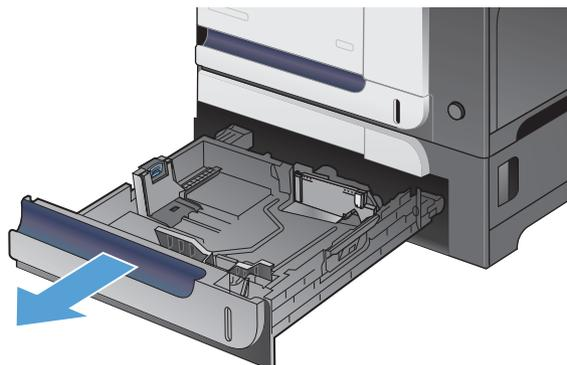
2. Отрегулируйте ограничитель длины и ширины бумаги: нажмите на регулировочные защелки и переместите ограничители на длину/ширину используемой бумаги.
