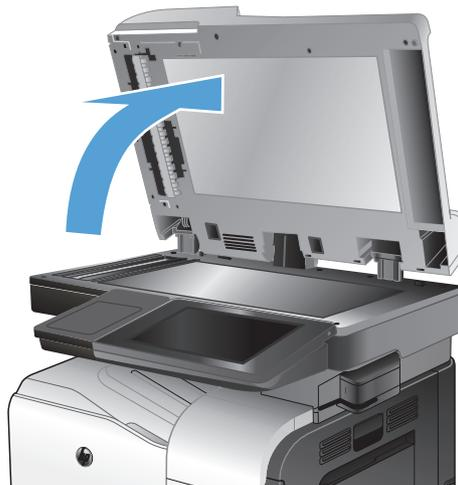
2. Положите книгу на стекло сканера, расположив корешок в соответствии с отметкой в центре задней части стекла сканера.
