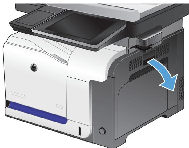
2. Если замятие произошло при поступлении бумаги в выходной приемник, осторожно потяните и извлеките ее.
