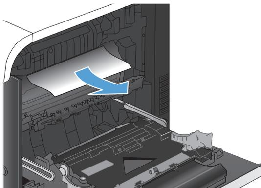
9. Бумага также может быть замята внутри термоэлемента, где она не видна. Возьмитесь за ручки термоэлемента и плавно потяните наружу, чтобы извлечь его.
