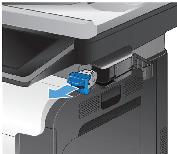
3. Вставьте новый картридж шивателя в проем внутри дверцы шивателя.
