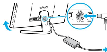
Отрегулируйте угол наклона экрана для доступа к разъему источника питания постоянного тока DC IN за подставкой. Протяните кабель адаптера переменного тока через отверстие в подставке и вставьте его в разъем источника питания постоянного тока DC IN. Подключите шнур питания к адаптеру переменного тока, а затем в розетку переменного тока.
