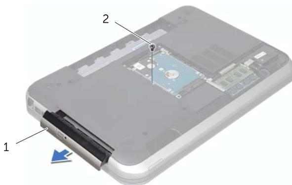
1 оптический дисковод в сборе    2 винт
