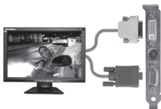
Рис. 2.16. Подключение монитора к компьютеру Kraftway Credo
