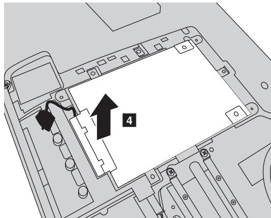
**Примечание.** Извлекайте жесткий диск (в металлическом корпусе) осторожно, чтобы не допустить обрыва соединения с разъемом SATA.
