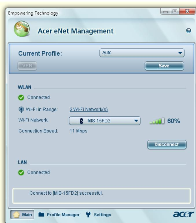
Утилита Acer eNet Management позволяет сохранять сетевые настройки для разных мест в соответствующих профилях и автоматически применяет их, когда пользователь передвигается из одного места в другое. Сохраняются такие настройки, как параметры подключения к сети (IP-адреса и параметры сервера DNS, сведения о беспроводной точке доступа и т.д.), а также стандартные настройки принтера. Из соображений безопасности утилита Acer eNet Management не сохраняет имя пользователя и его пароль.
