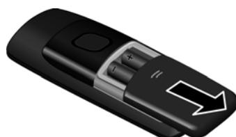
Если необходимо открыть крышку аккумуляторного отсека, например, для замены аккумуляторов, возьмитесь за выемку в верхней части крышки и сдвигайте крышку вниз.
