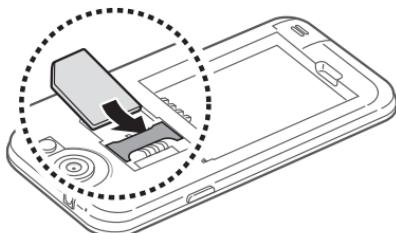
**!** Антенна располагается вверху на задней стороне устройства. Чтобы избежать повреждений антенны, не отрывайте защитную ленту, закрывающую ее.
