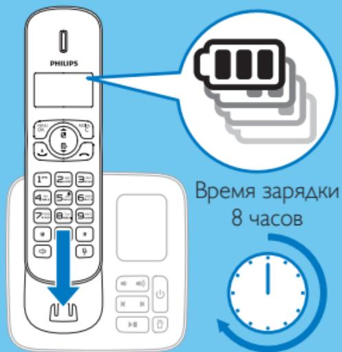
Для зарядки телефонной трубки поместите ее на базу. Если трубка правильно установлена на базовую станцию, прозвучит краткий сигнал установки.
