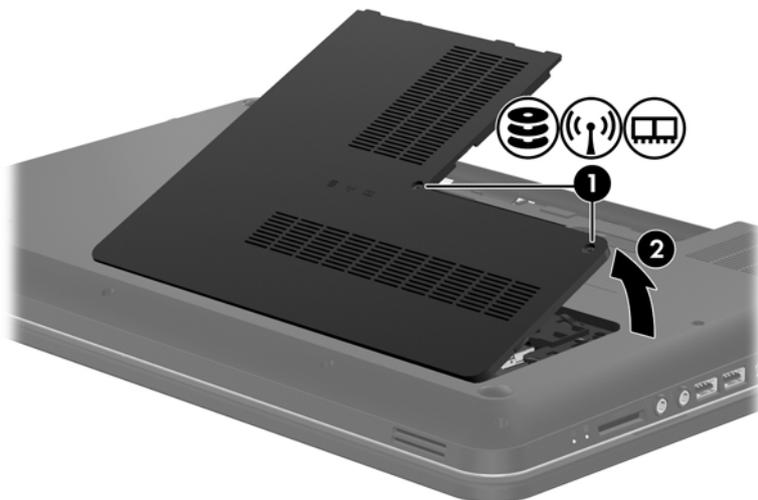
6. При замене модуля памяти извлеките установленный модуль памяти следующим образом.
