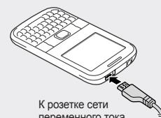
Перед извлечением аккумулятора необходимо отсоединить зарядное устройство. В противном случае в работе телефона могут возникнуть неполадки.
