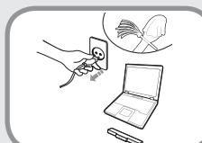
**Отсоедините все кабели, подключенные к компьютеру, перед его очисткой. При использовании ноутбука извлеките батарею.**
