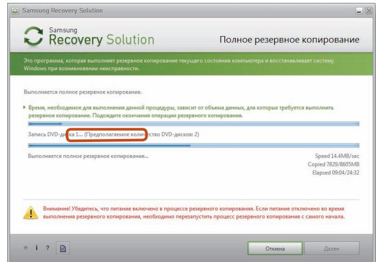
**6** Когда после завершения резервного копирования отобразится сообщение "Перезагрузите систему", нажмите кнопку **OK** для перезагрузки системы.
