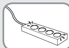
**Подсоедините кабель питания сетевой розетке разветвителю (удлинителю) с контактом заземления.**
