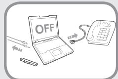
Перед разборкой компьютера выключите его и отсоедините все кабели. Если имеется модем, отсоедините телефонный кабель. Если используется ноутбук, обязательно извлеките батарею.
