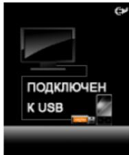
После подключения плеера к компьютеру, все операционные системы опознают его автоматически, и в папке **“Мой компьютер”** появятся две иконки: **“teXet”** (Память), **“Съемный диск”** (microSD карта).
