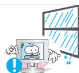
► Не устанавливайте устройство в месте, подверженном воздействию влаги, пыли, дыма, воды, а также внутри автомобиля.
