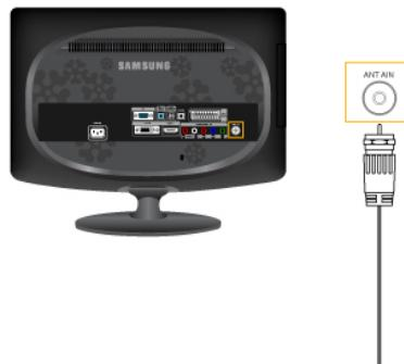
1. Подсоедините кабель САТВ или кабель ТВ-антенны к порту «ANT IN» на задней панели монитора.
