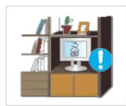
► Не устанавливайте устройство в местах с плохой вентиляцией, например в книжном или стенном шкафу.
