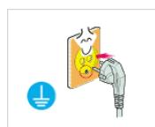
► Обязательно подключайте кабель питания к заземленной сетевой розетке.
