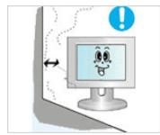
► Устанавливайте устройство в хорошо проветриваемом помещении. Между стеной и устройством должно быть расстояние не меньше 10 см.
