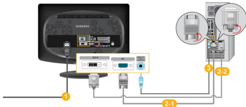
**1** Подключите кабель питания монитора к порту POWER на задней панели монитора.
