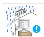
► Перегните кабель внешней антенны вниз в месте подсоединения так, чтобы дождевая вода не попадала на него.
