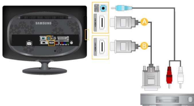
1 Подключите выходной разъем DVI устройства цифрового вывода к разъему [A HDMI IN1] или [B HDMI IN2] монитора с помощью кабеля DVI-HDMI.
