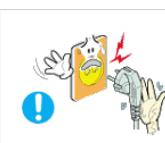
Не дотрагивайтесь до вилки кабеля питания мокрыми руками при подключении ее к сетевой розетке или извлечении из нее.
