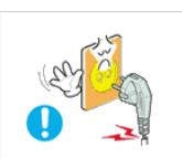
Не используйте поврежденную вилку или кабель питания, а также поврежденную или незакрепленную сетевую розетку.
