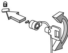
Обмотайте кабелем замка безопасности для компьютеров неподвижный предмет, например, стол или ручку запертого ящика. Вставьте замок в выемку и поверните ключ, чтобы запереть замок. Бывают и модели замков без ключей.
