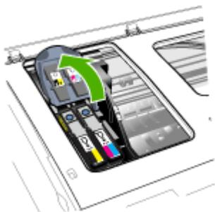
5. Поднимите ручку печатающей головки и взявшись за нее, извлеките головку из паза.
