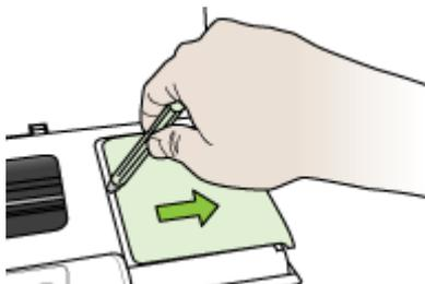
3. Отожмите фиксатор печатающей головки вверх.
