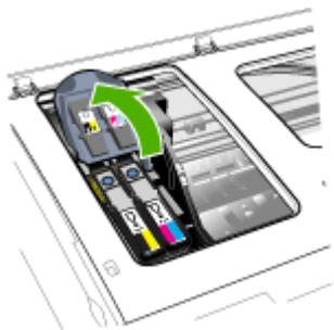
5. Поднимите ручку печатающей головки, которую вы хотите заменить, и взявшись за нее, извлеките головку из паза.
