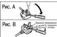
2. Замените плавкий предохранитель и закройте или прикрепите крышку отсека.
