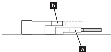
Чтобы убедиться, что модуль SO-DIMM установлен надлежащим образом, выполните следующие действия.
