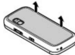
2. Если аккумулятор установлен, извлеките его в направлении стрелки.
