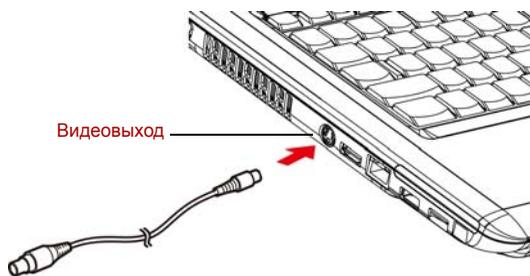
Рисунок 8-11 Подключение телевизора
