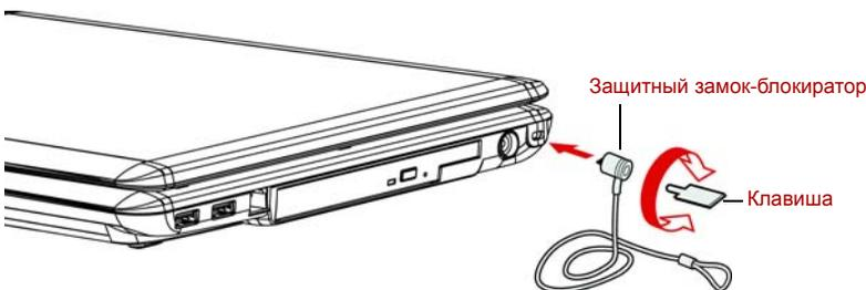
*Рисунок 8-13 Защитный замок-блокиратор*
