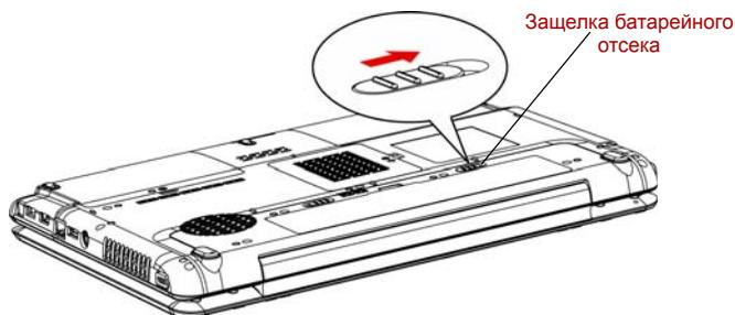
*Рисунок 6-1 Сдвиньте блокирующую защелку в разомкнутое положение*
