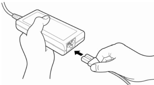
*Рисунок 3-1 Подключение шнура питания к адаптеру переменного тока*
