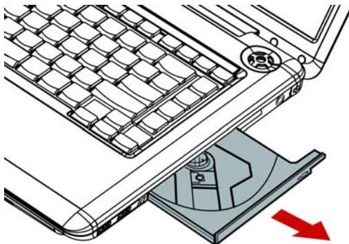
*Рисунок 4-5 Вытягиваем лоток*
