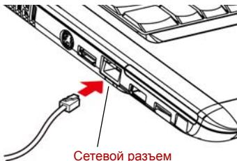
Рисунок 4-15 Подключение сетевого кабеля
