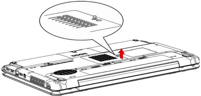
Рисунок 8-7 Снимаем крышку
