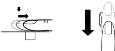
Рисунок 4-2 Проведите пальцем по поверхности распознающего датчика
