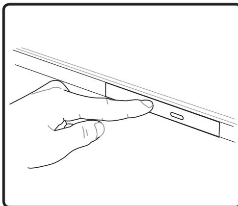
4. Медленно задвиньте лоток привода на место. Привод начинает чтение оглавления диска. Когда он остановится, диск будет готов к использованию.
