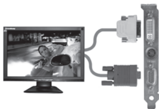
Рис. 2.16. Подключение монитора к компьютеру Kraftway Credo
