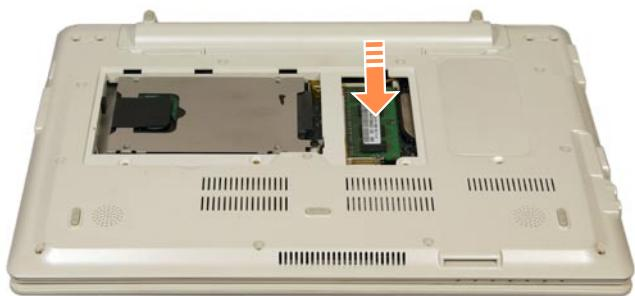
**5** Закройте крышку отсека модуля памяти/жесткого диска и затяните винты.
