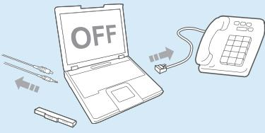
Перед разборкой компьютера выключите его и отсоедините все кабели. Если имеется модем, отсоедините телефонный кабель. Если используется ноутбук, обязательно извлеките батарею. Несоблюдение этих инструкций может привести к поражению электрическим током.
