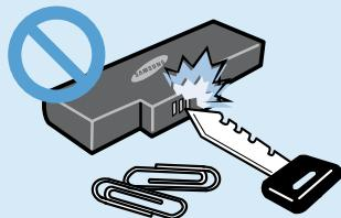
**Не допускайте контакта клеммы батареи (металлические детали) с металлическими объектами, например ключами или зажимами.**
