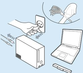
Отсоедините все кабели, подключенные к компьютеру, перед его очисткой. При использовании ноутбука извлеките батарею.
