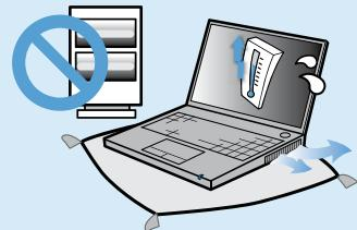
**Во избежание перегрева не используйте компьютер в местах с плохой вентиляцией, например на постельном белье, на подушке и т.д., а также в помещении с подогреваемым полом.**
