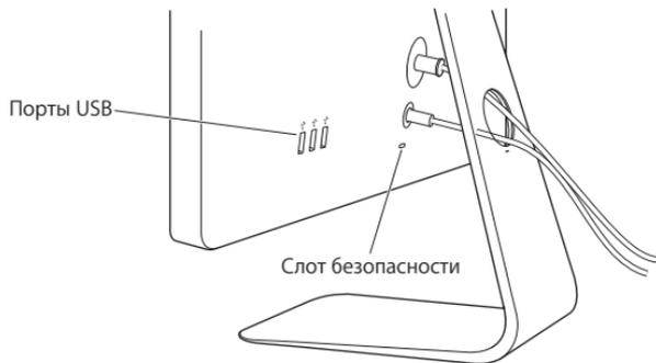
Чтобы обезопасить монитор, используйте слот безопасности для подключения соединительного кабеля.
