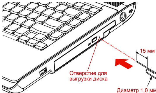
Рисунок 4-3 Открываем лоток вручную через отверстие для выгрузки диска
