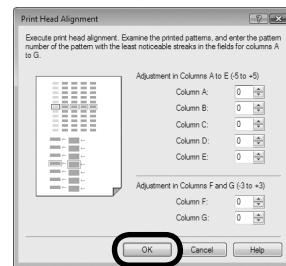
Рассмотрите первую распечатку и введите номер образца с наименее заметными вертикальными и горизонтальными полосами в столбцы от А до G, затем нажмите кнопку [OK] (в среде Macintosh — [Send/Отправить]).
