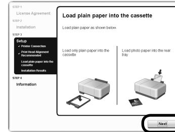
При появлении экрана [Load plain paper into the cassette/Загрузка обычной бумаги в кассету] загрузите обычную бумагу в кассету и нажмите кнопку [Next/Далее].
