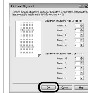
Рассмотрите первую распечатку и введите номер образца с наименее заметными вертикальными и горизонтальными полосами в столбцы от H до Q, затем нажмите **[OK]** (в среде Macintosh — **[Send/Отправить]**).
