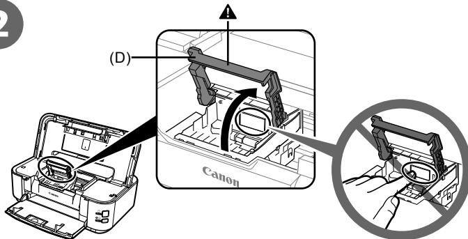
Поднимите рычаг-фиксатор печатающей головки (D).
