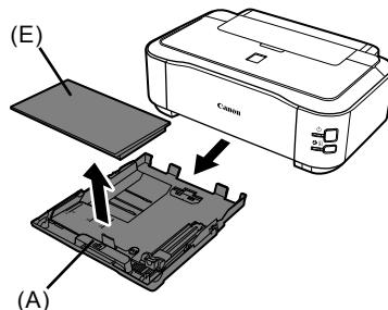
Извлеките кассету (A) и снимите крышку (E).
