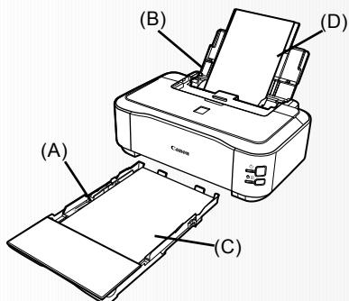
В кассету (A) можно загружать только обычную бумагу (C). Чтобы выполнить печать на бумаге [Фотобумага/Hagaki] (D), загружайте ее только в задний лоток (B).
