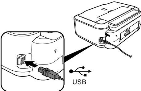
При отображении диалогового окна [Printer Connection/Подключение принтера] подключите один конец кабеля USB к компьютеру, а другой — к принтеру и ВКЛЮЧИТЕ ПРИНТЕР.
