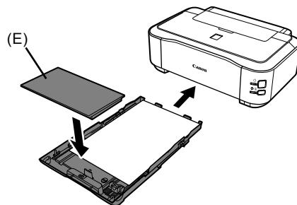
Установите крышку (E) и вставьте кассету в принтер до фиксации со щелчком.
