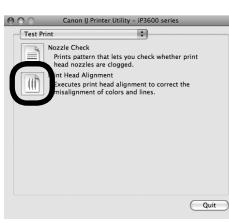
Выберите [Print Head Alignment/Выравнивание печатающей головки] на вкладке [Maintenance/Обслуживание] в диалоговом окне свойств принтера. (В среде Macintosh выберите [Print Head Alignment/Выравнивание печатающей головки] для пункта [Test Print/Пробная печать] в разделе Canon IJ Printer Utility.)
