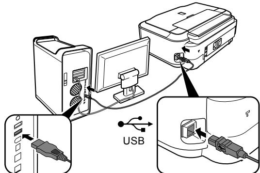
Подключите один конец кабеля USB к компьютеру, а другой — к принтеру, затем включите компьютер и вставьте [Setup CD-ROM/Установочный компакт-диск] в устройство считывания компакт-дисков.
