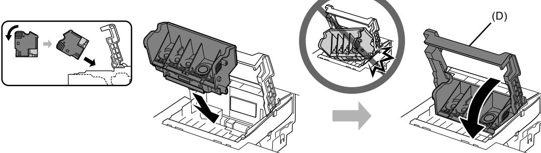
Наклоните печатающую головку и установите ее на место. Полнстью опустите рычаг-фиксатор печатающей головки (D).
