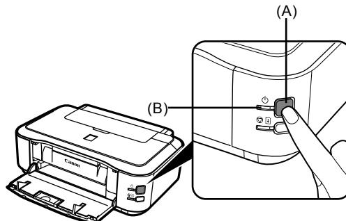
Нажмите кнопку **ВКЛ.** (A), чтобы ВЫКЛЮЧИТЬ ПРИНТЕР. Включите компьютер и вставьте *[Setup CD-ROM/Установочный компакт-диск]* в устройство считывания компакт-дисков.
