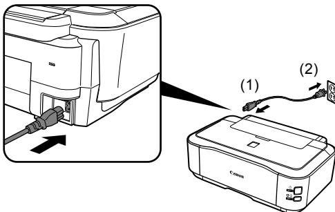
Подсоедините кабель питания к разъему на левой стороне задней панели принтера и вставьте штепсель в электрическую розетку.
