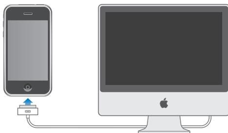
**Важно:** Зарядка iPhone 3G с помощью адаптера питания для порта FireWire или автомобильного зарядного устройства, совместимого с FireWire, невозможна. Если iPhone подсоединен к компьютеру, который выключен или находится в спящем режиме либо в режиме ожидания, аккумулятор iPhone может терять заряд.
