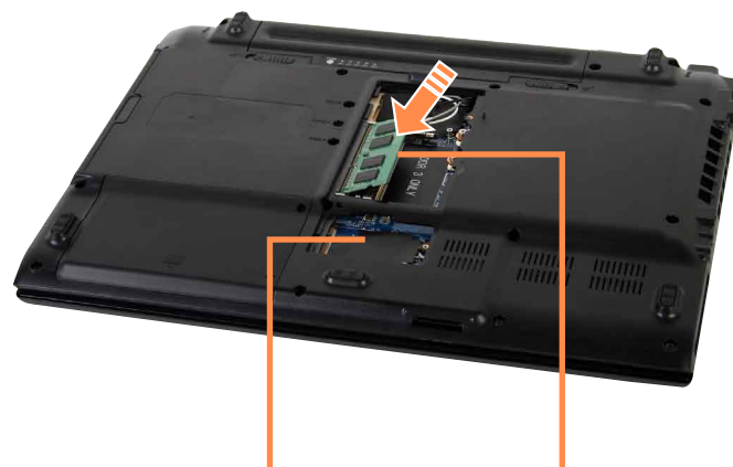
Гнездо модуля Intel Turbo Memory
