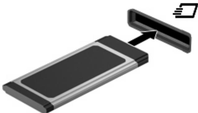
При обнаружении устройства будет слышен звуковой сигнал и может появиться меню доступных параметров.
