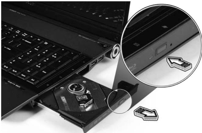
При отключенном питании лоток привода можно открыть, вставив тонкий стержень в отверстие аварийного извлечения.
