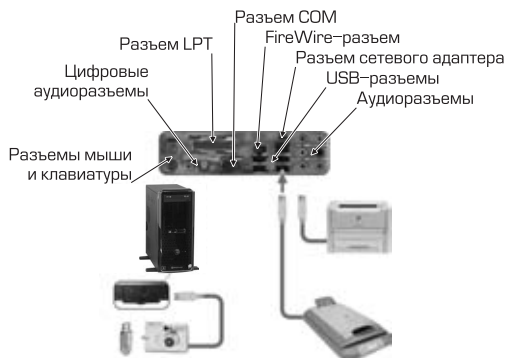
Рис. 6.1. Подключение USB, COM и LPT-устройств
