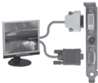
Рис. 2.16. Подключение монитора к компьютеру Kraftway Idea
