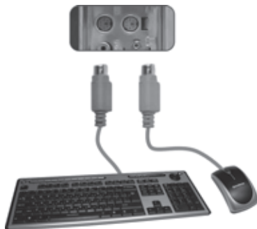
Рис. 3.3. Подключение мыши и клавиатуры
