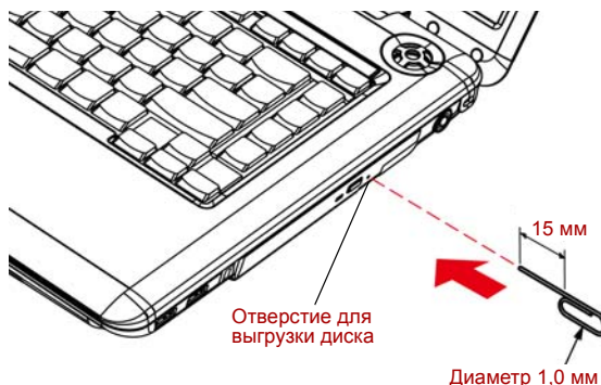
Рисунок 4-4 Открываем лоток вручную через отверстие для выгрузки диска
