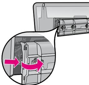
6. Извлеките замятую бумагу со стороны задней панели принтера и аккуратно установите на место заднюю дверцу.
