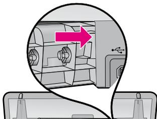
7. Если замятую бумагу не удастся извлечь со стороны задней панели принтера, поднимите крышку принтера, удалите замятую бумагу с передней стороны принтера и опустите крышку.
