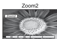
Отображает изображение "16:9" в стиле почтового ящика (анаморфотное) на всем экране без искажения.
