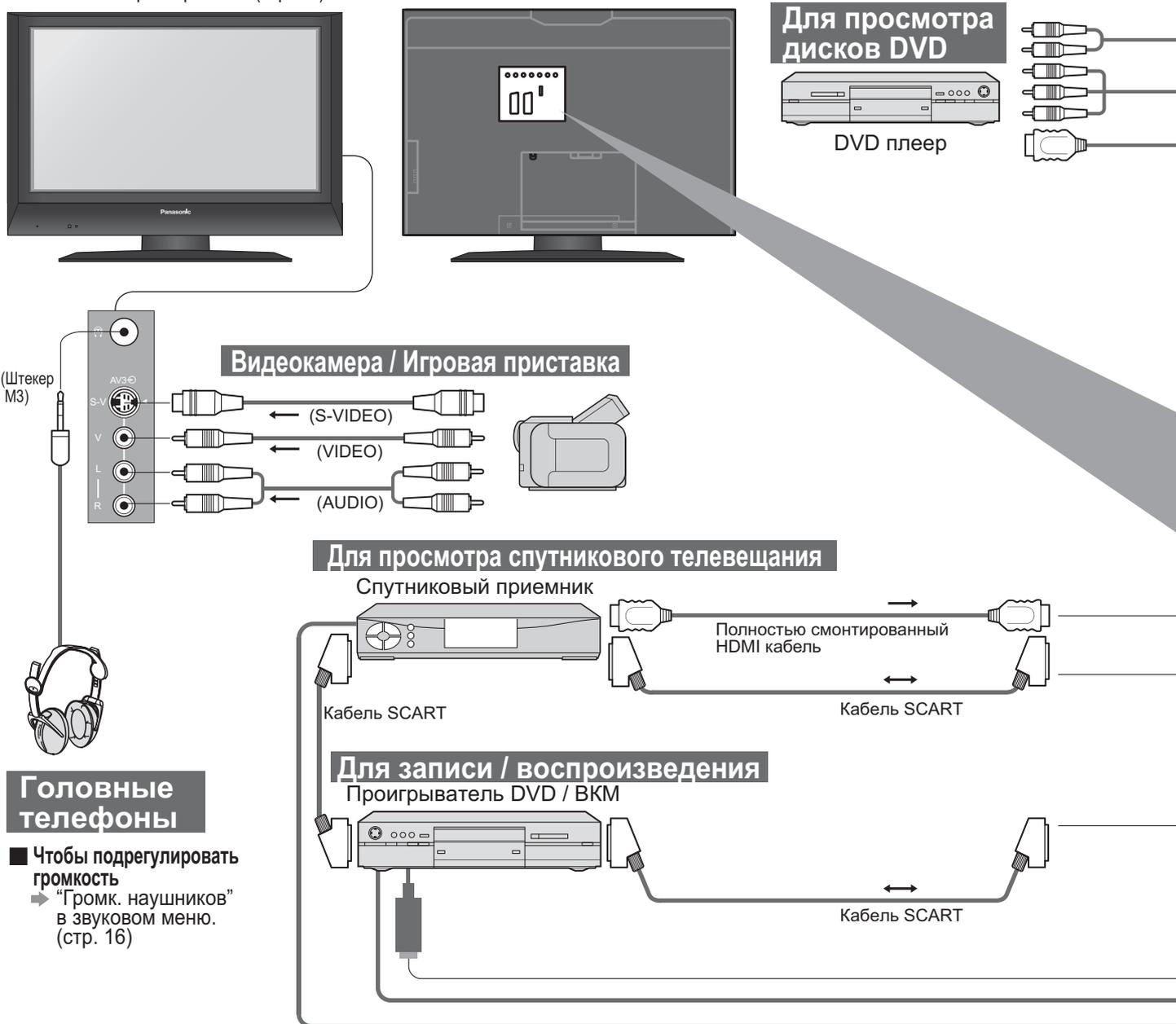
Типы оборудования, которое можно подсоединить, для каждого соединителя
