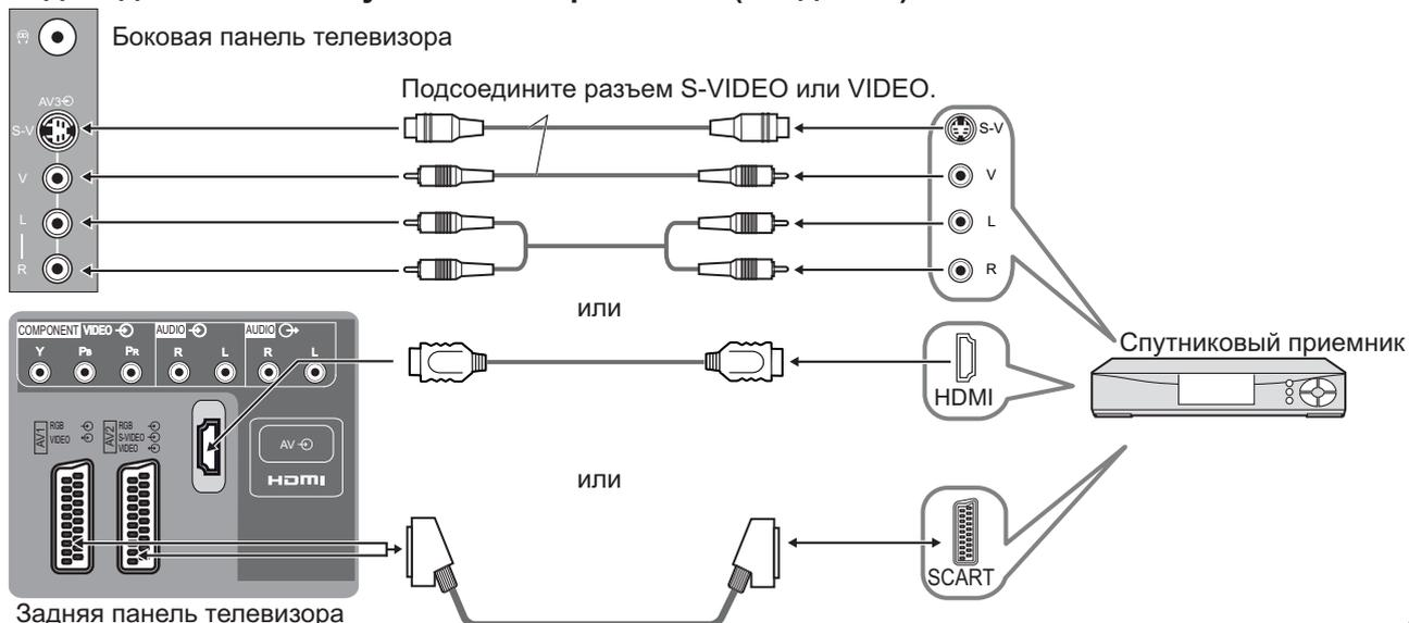
■ Подсоедините ВКМ / проигрыватель DVD и блок спутникового приемника (пример)
